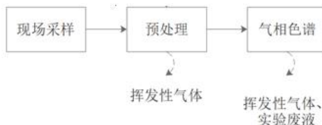
图 2-5 气相色谱法测定挥发性有机物的工艺流程及产污环节
