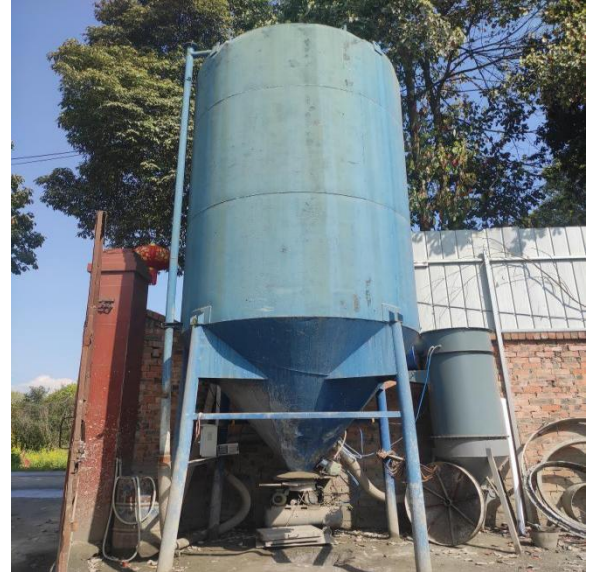
水泥筒仓+脉冲布袋除尘器
