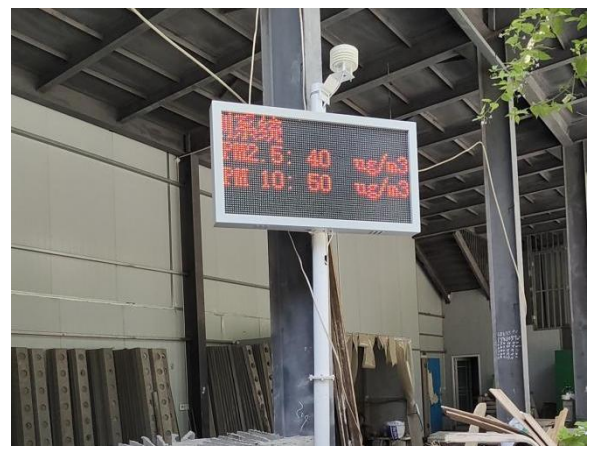
扬尘在线视频监测系统
