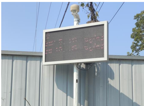
扬尘在线视频监测系统
