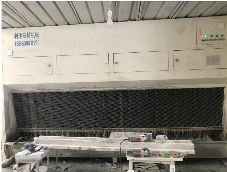
水洗式除尘器
