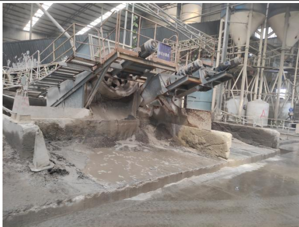
二级沉淀池+砂石分离机+废水废浆收集利用池+储水罐
