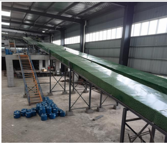
炉渣全密闭输送皮带
