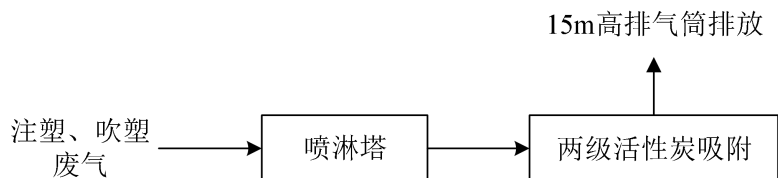
图 3-1 有机废气处理工艺流程图
