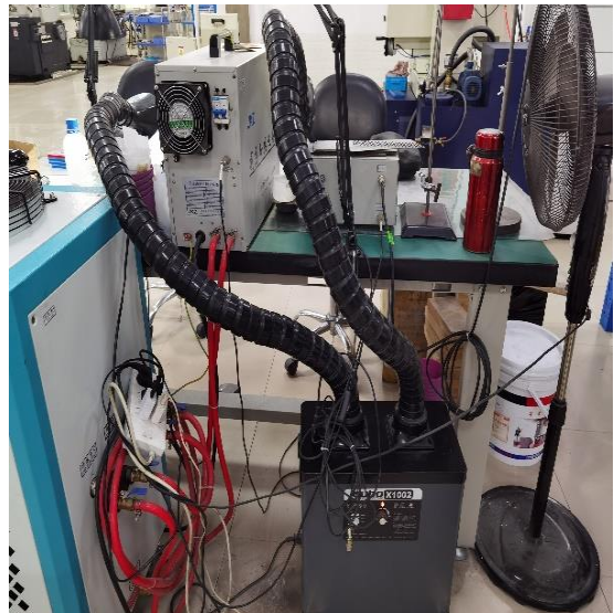
手工打磨工位与高频焊接工位共用 1 台移动焊烟净化器
