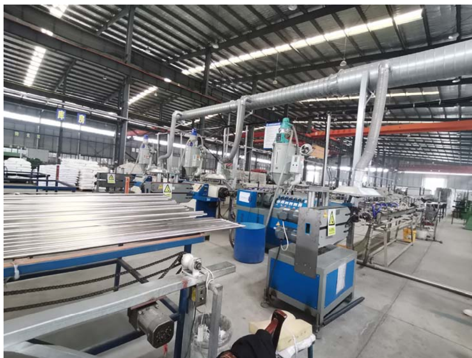
图 3-1 外覆塑生产线和废气集气罩
