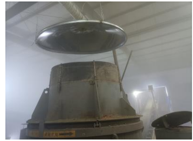
1#厂房盾构料分离生产线粉尘收集设施、除尘器及喷雾降尘系统
