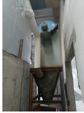
1#厂房盾构料分离生产线粉尘收集设施、除尘器及喷雾降尘系统
