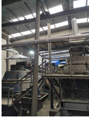
1#厂房盾构料分离生产线粉尘收集设施、除尘器及喷雾降尘系统
