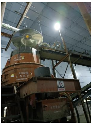
2#厂房盾构料分离生产线粉尘收集设施、除尘器及喷雾降尘系统
