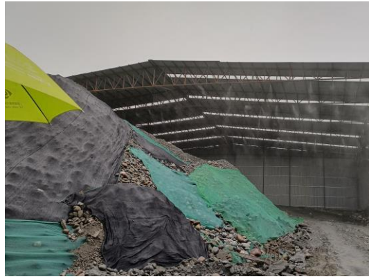
2#厂区原料堆场及喷雾降尘
